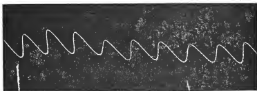
Fig. 10. — La 3 , 50 vibrations (levier : 0.06 de long) On retrouve 870 vibrations en faisant la somme des vibrations partielles Si on annule l'influence du levier, on obtient la figure 11
